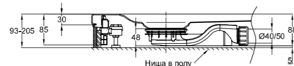
B597-*, Арматура слива BetteSolid 30 - 0,6 л/с Рис.: с боковым водоотводом, высота гидравлического затвора 30 мм согл. DIN/EN 274
