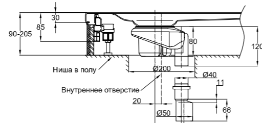
B573-*, Арматура слива BetteDown - 0,6 л/с Рис.: с вертикальным водоотводом, высота гидравлического затвора 50 мм согл. DIN/EN 274
