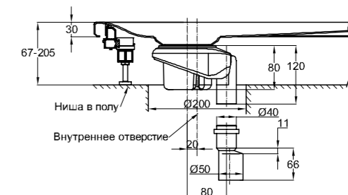
B573-*, Арматура слива BetteDown - 0,6 л/с Рис.: с вертикальным водоотводом, высота гидравлического затвора 50 мм согл. DIN/EN 274
