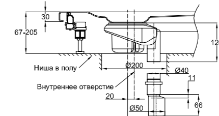
B573-*, Арматура слива BetteDown - 0,6 л/с Рис.: с вертикальным водоотводом, высота гидравлического затвора 50 мм согл. DIN/EN 274
