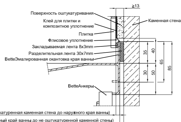
Установка у стены с массивной конструкцией
